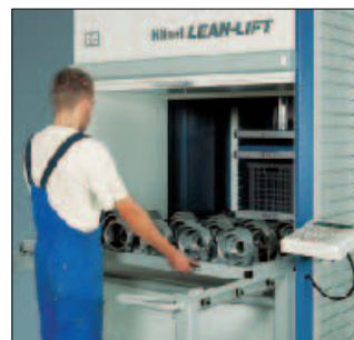
A tároló tálca betolható a kiszolgáló nyíláson ...
