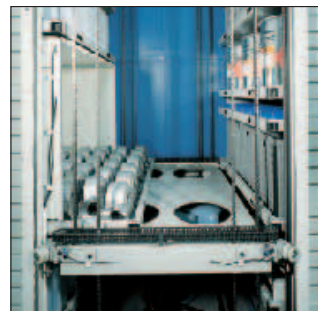
A tároló tálcat az liftegység mozgatja ...
