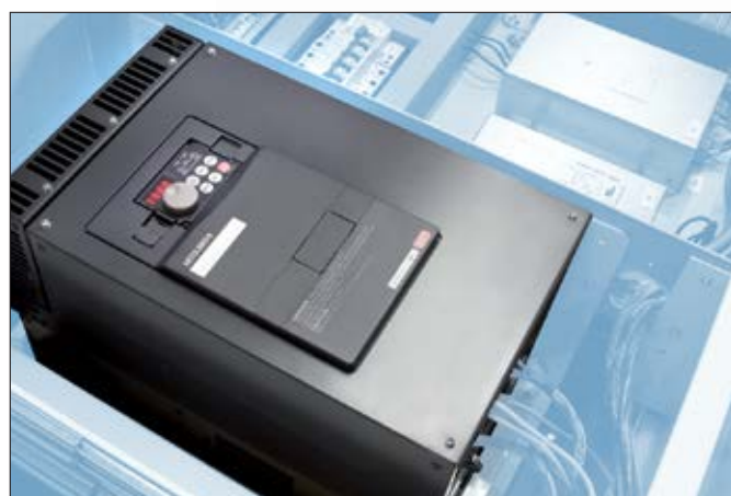
Frekvenciaváltó a Hänel Lean-Lift® EcoDrive®-ban
