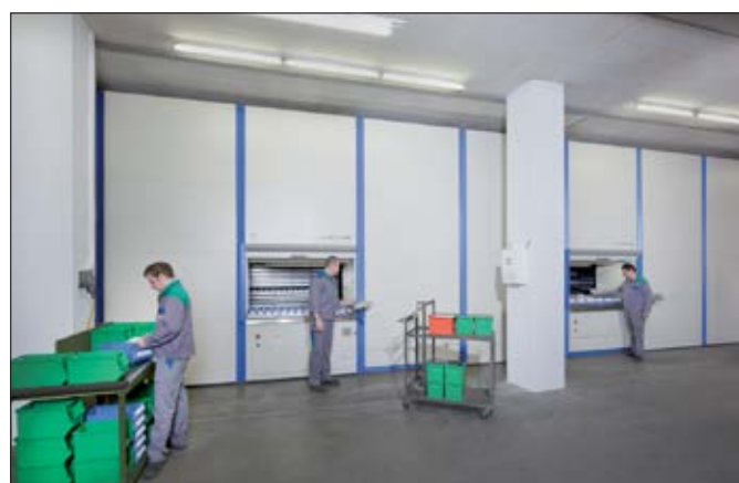
Két 9.57 m széles Hänel Multi-Space® alkotja a gyártósornak központi raktárát
