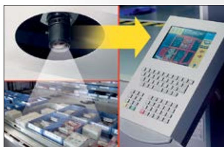
A tételről fénykép készül, a kép közvetlenül a vezérlő egység kijelzőjén jelenik meg.
