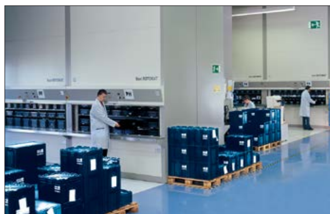
Antisztatisztikus tárolás Hänel Rotomat® ipari páternoszterben közvetlenül a gyártósor mellett
